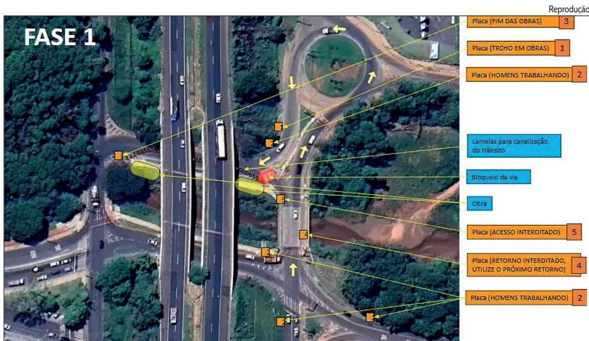
Indicativos da concessionária sobre intervenções e interdições na ponte sobre o Córrego dos Macacos
